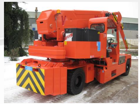
Zavorre rimovibili (7.300 kg) per facilitare il trasporto della gru
