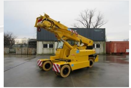
Rallonge hydraulique tournable inclinable sur le coté, disponible comme accessoire
