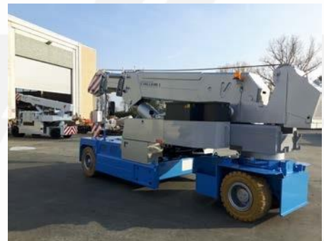
EChâssis extensible de série pour augmenter la capacité de charge
