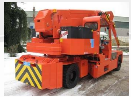
Lest détachable (7.300 kg) pour faciliter le transport de la grue
