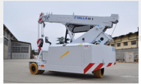
Ruota sterzante posteriore con 180° di rotazione per la massima manovrabilità
