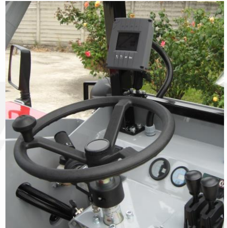
Cabina operatore con comandi ergonomici e display digitale per sistema di limitazione del carico
